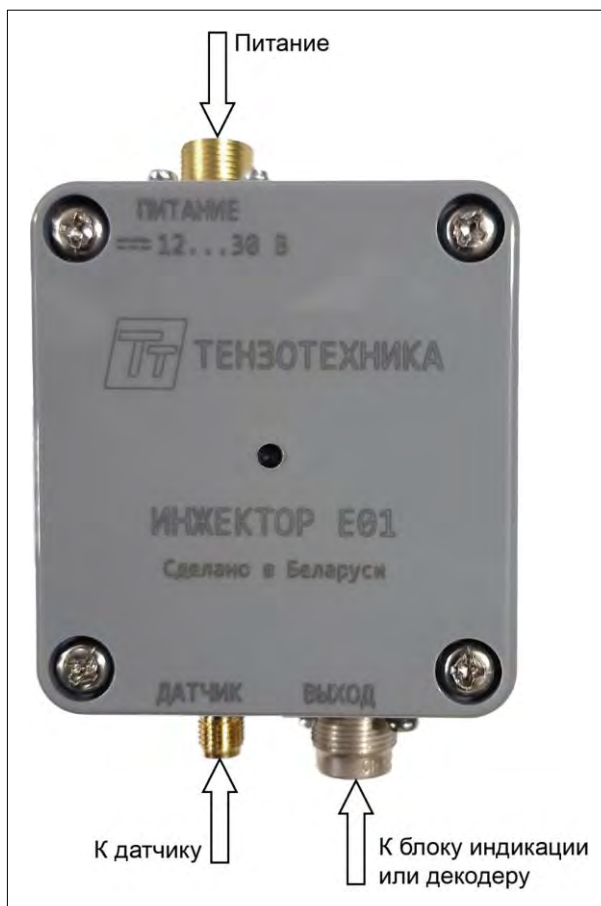
Рис. 4 – Инжектор E01(слева) и кабель для подключения декодера к инжектору (справа).
